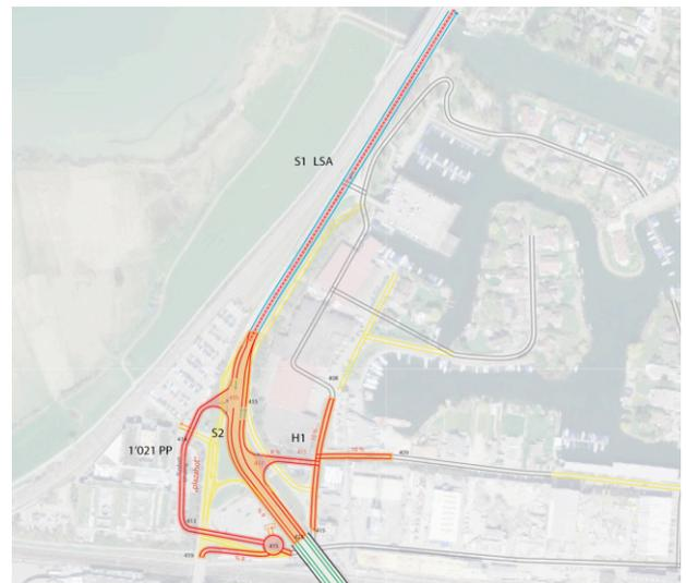
Abb. 20 Verkehrssystem Hurdnerfeld, reduzierte Zielzustand ohne LSA: Infrastrukturbedarf.
